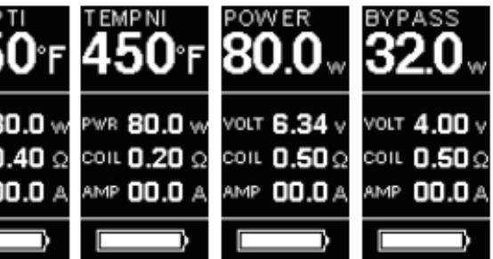
2. Nach dem Sie die Feuertaste 3 Mal gedrückt haben, blinken die ersten beiden Zeilen um anzuzeigen, dass Sie nun im Menü sind. Drücken Sie die rechte Taste, um zwischen den Modi VW, BYPASS, VT-Ni, VT-Ti, VT-SS316 und TCR Modus zu wechseln. Drücken Sie die Feuer-Taste, oder lassen Sie das Display 10-mal blinken um die aktuellen Einstellungen zu bestätigen und das Menü zu verlassen.
