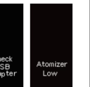
**Allarme di atomizzatore basso:** Quando la resistenza di atomizzatore è inferiore 0.1ohm in modalità VW o 0.05ohm in modalità VT, lo schermo visualizzerà "atomizzatore basso".
