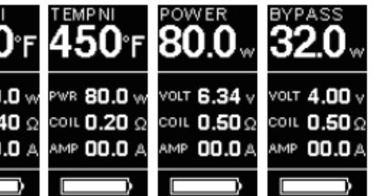
2. Despues de pulsar el botón de encendido 3 veces, la primera fila parpadeará para indicar que entrará al menú. Pulse el botón regulador derecho para cambiar entre los modos VW, BYPASS, VT-Ni, VT-Ti, VT-SS316 y TCR. Pulse el botón de encendido o salir de la pantalla, parpadeará 10 veces para confirmar y salir del menú.
