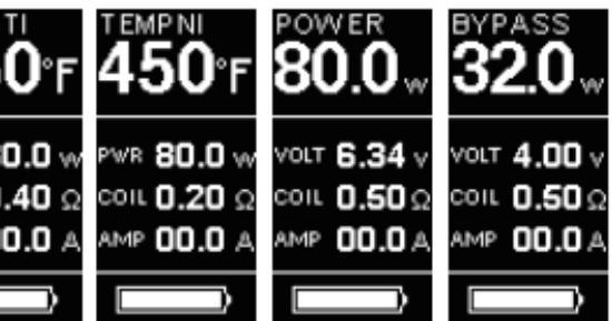
2. Dopo aver premuto il pulsante di fuoco per 3 volte, la prima riga lampeggia per indicare che si e' entrata nel menu. Premere il tasto di regolamento adatto per passare da modalità VW, BYPASS, VT-Ni, VT-To, VT-SS316 e TCR . premere il pulsante di fuoco, o lasciare il display lampeggiare 10 volte su l'impostazione corrente per confermare e uscire dal menu.
