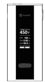
**Basculer entre les modes VW/VT-Ni / VT-Ti / VT-SS316 et le mode TCR.****1. Appuyer sur le bouton de tir 3 fois pour entrer dans le menu.**
